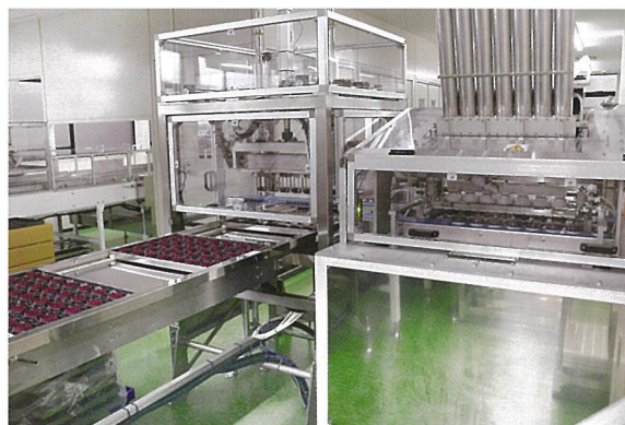
オープンから出た薔薇甘は、冷却コンベヤで冷ました後、取り出され、カップ蓋供給装置へ
