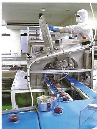
自動でカップの蓋をした後、包装工程へ送られる
