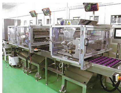
カップディスペンサーでカップを供給しカメラで検査。その後、2種類の中味を絞る
